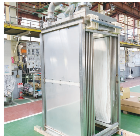
佐野浄水場 膜ろ過ユニット(28基) (設計はメーカー様)
