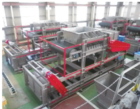
岡山県倉敷市 JFEスチール(株) コンスタントフィーダ(24台)
