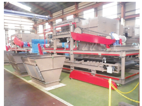
岡山県倉敷市 JFEスチール(株) コンスタントフィーダ(24台)
