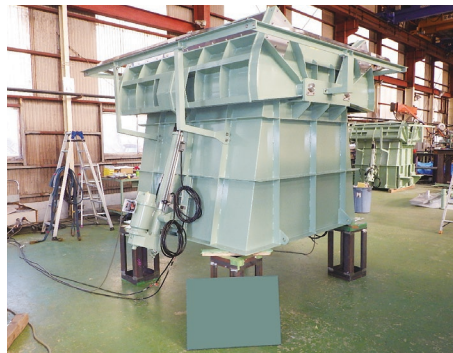
大滝根水環境センター 汚泥貯留ホッパ
