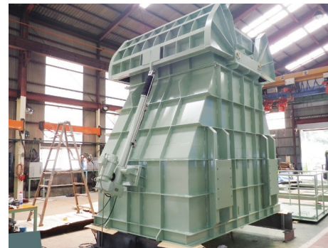
村山浄化センター 10m 3 カットゲート
