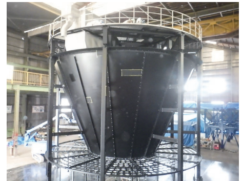
日本製紙(株) 石巻工場 クラリファイヤ (設計はメーカー様)
